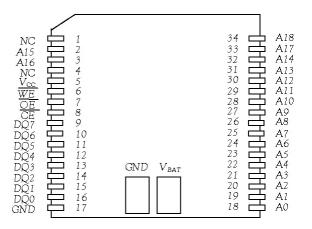
34-Pin PowerCap Module (PCM) (Uses DS9034PC PowerCap)
